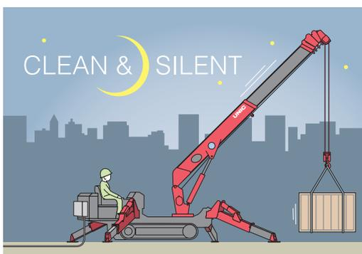
排出ガスゼロ。エンジン騒音がないので、夜間の市街地や屋内での作業・移動時などにクリーン＆サイレントなクレーン作業を実現します。エンジンと電動モータの切り替えもカンタンです。
